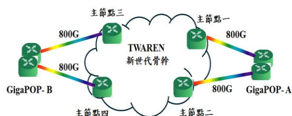
圖2.2.2 GigaPOP 連線至雙主節點架構示意圖
