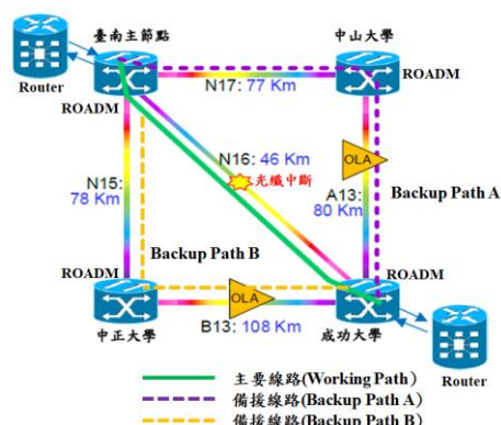
圖2.1.3 光傳輸網路系統 Restore 運作圖例
