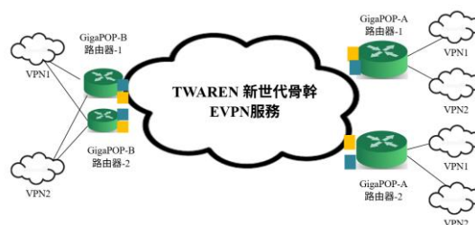
圖2.2.4 新世代骨幹 EVPN 服務應用架構
