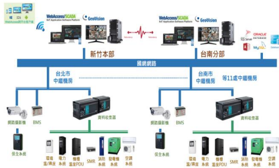
圖五：中繼機房專屬環控架構
